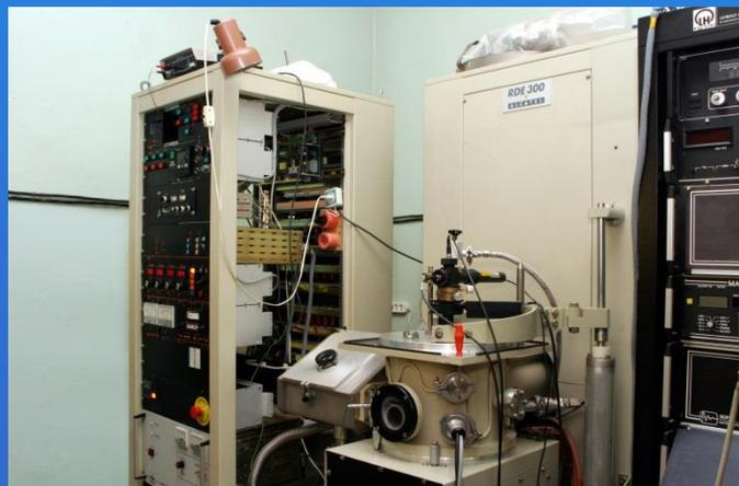
*Установка реактивно-ионного травления
