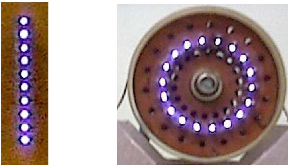
Рис. 7. Внешний вид моделей линейного и кольцевого источников УФ. Потребляемая мощность одной линейки или кольца до 100 Вт при напряжении до 3 кВ. Искровые промежутки организованы с зазором 0,2–0,3 мм и шагом 1 см. Импульсно-периодические разряды с частотой до 1 кГц происходят между шайбами из Мо диаметром 3 мм. Искровые промежутки собраны с конденсаторами К15-5 (3.3 нФ, 3 кВ) по схеме Аркадьева-Маркса.
