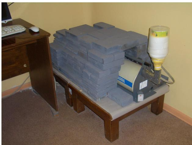
Рис. 26. Детектор  $\gamma$ -излучения Canberra GC3019 с криостатом в свинцовой защите, установленный в НИИЯФ МГУ.
